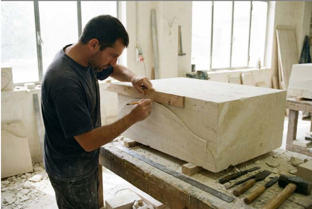
Utilisation de gabarit pour traçage précis sur pierre, tolérance d'assemblage maximale \pm 2 mm
